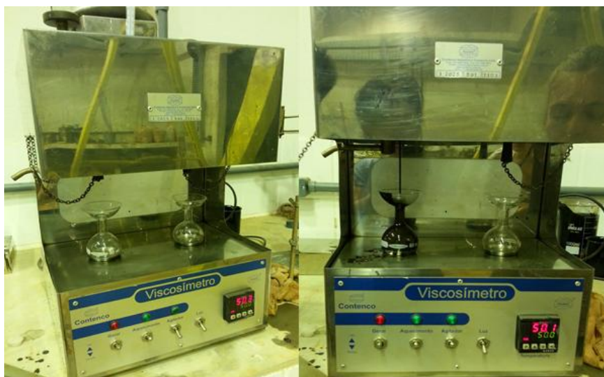
Figura 5.1 Ensaio de Saybolt-Furol para emulsões
