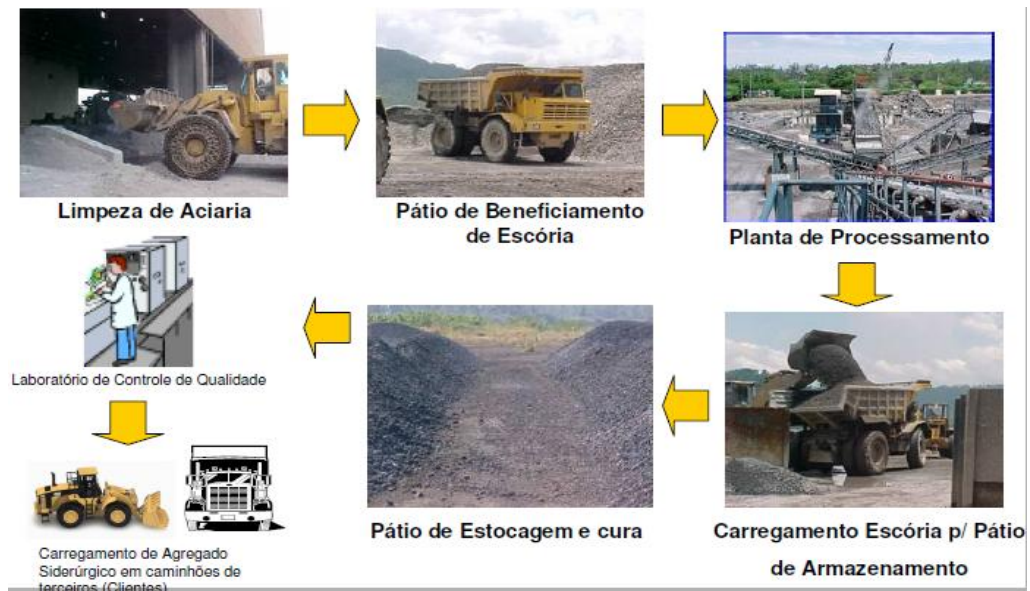
Figura 3.6 Fluxo do processo de beneficiamento da escória de aciaria
